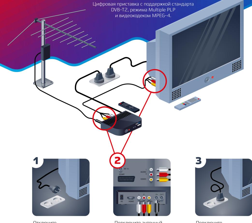
Отключите электропитание телевизора. Подключите антенный кабель к антенному входу цифровой приставки. Подключите видеои аудио кабель к соответствующим разъемам на телевизоре и цифровой приставке. Подключите электропитание и включите телевизор.
